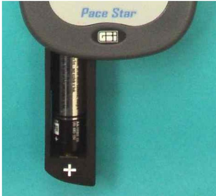
**Figura 4.6** Compartimento de Batería Abierto
